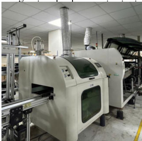
e. Công đoạn phun Flux
