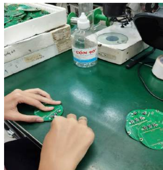
f. Công đoạn vệ sinh mạch
