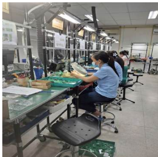
b. Đường ống thu gom khí thải từ các mỏ hàn tay
