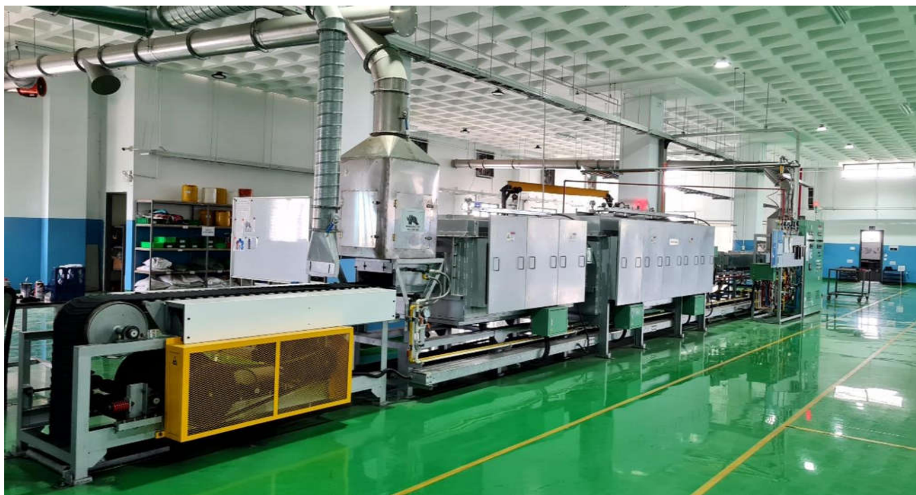
Hình III-20: Hình ảnh bổ sung xả khí của lò thiêu kết
