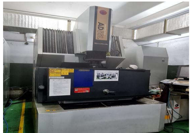
Hình I-5: Máy xung điện EDM
