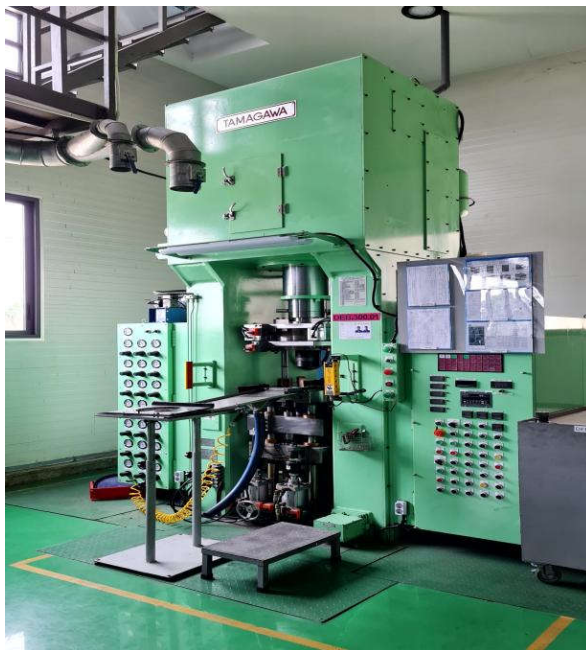
Hình I-17: Máy dập ép bột kim loại
