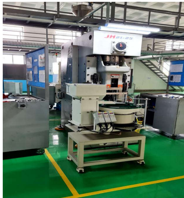
Hình I-17: Máy dập ép bột kim loại
