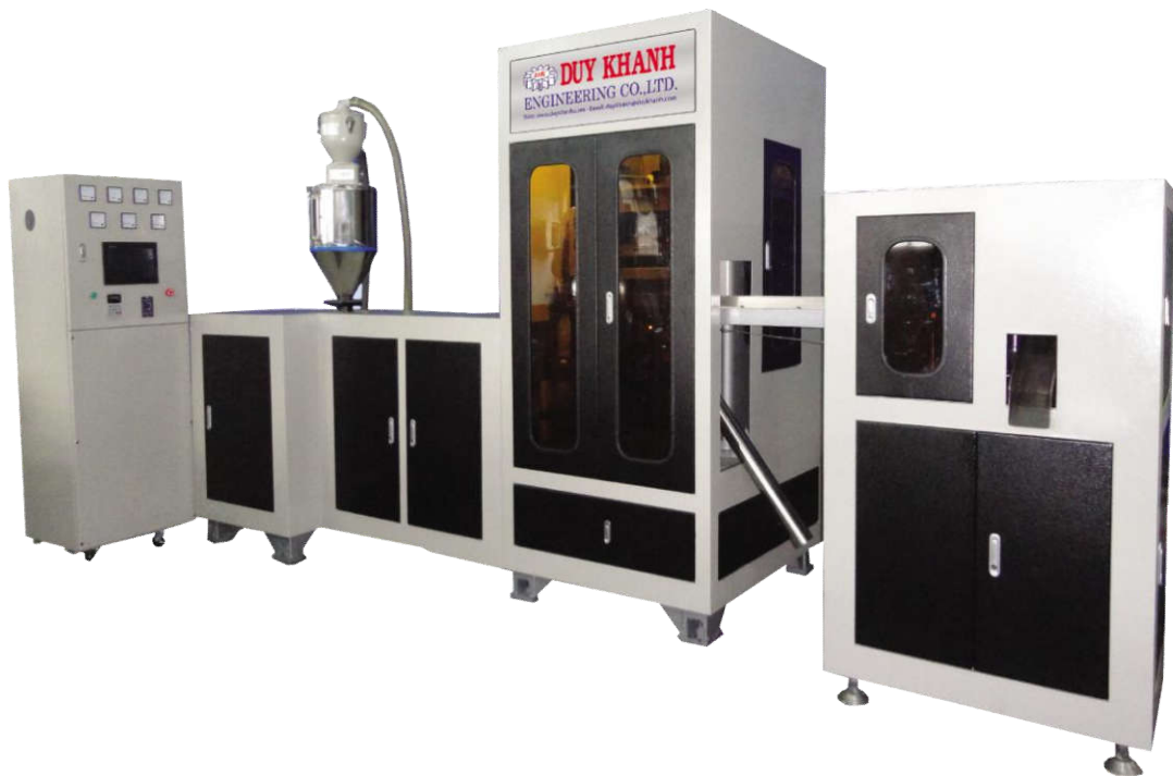
Hình I-15: Máy chuyên dụng sản xuất nắp chai sản xuất tại Duy Khanh
