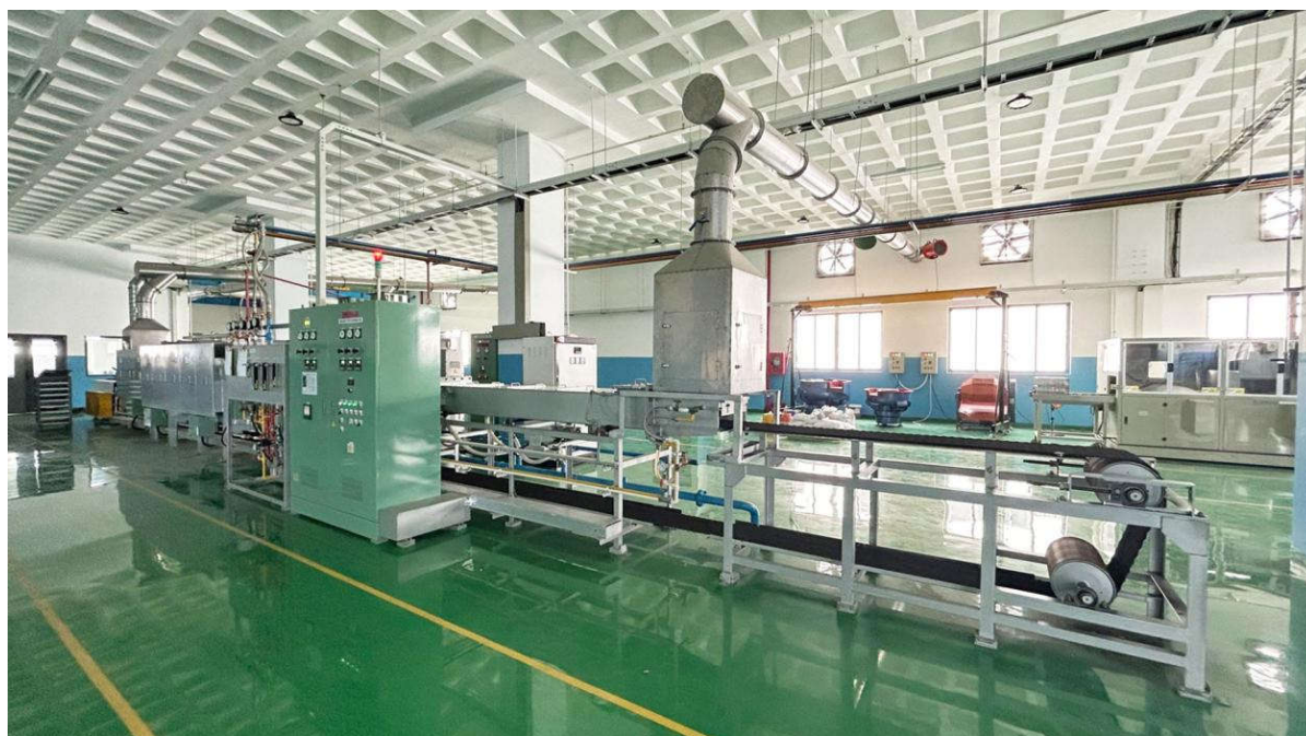
Hình III-21: Hình ảnh bổ sung xả khí của lò thiêu kết
