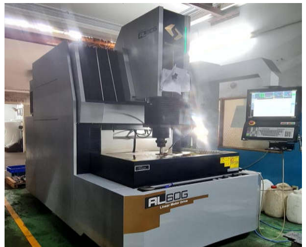
Hình I-12: Máy xung điện EDM
