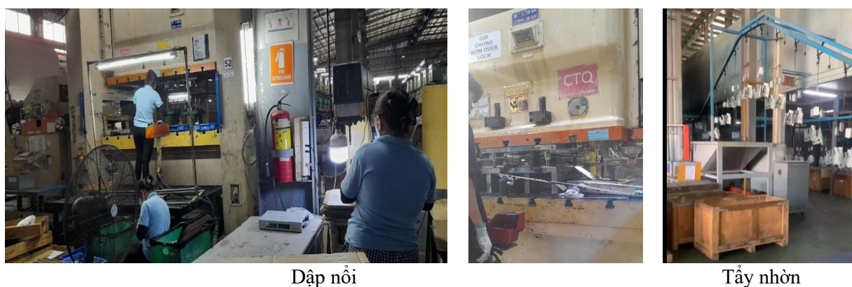
Hình 1.5 Hình ảnh thực tế của quy trình sản xuất kim loại dập hình nổi chính xác
