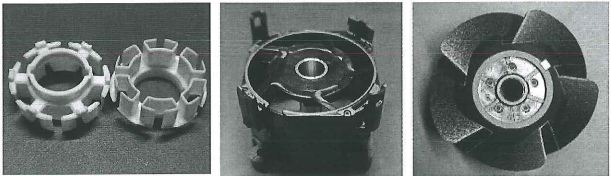
Hình 1.3 Một số linh kiện bằng nhựa được sản xuất tại Dự án
